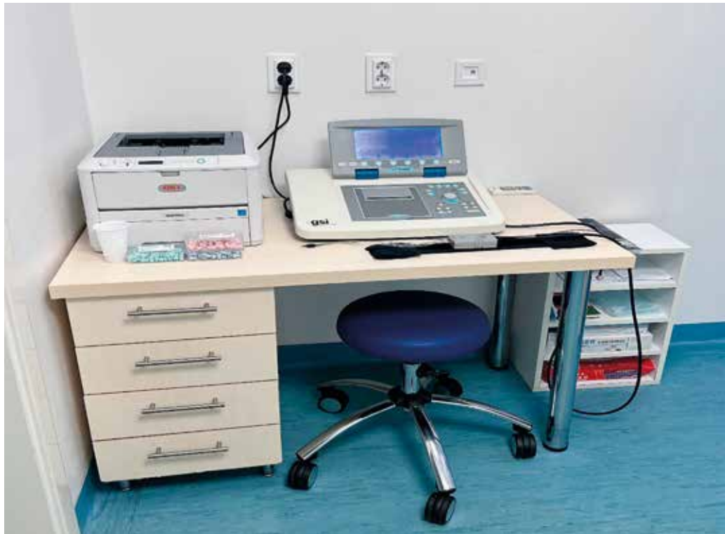
► Timpanometar (stari) – timpanometrija, ispitivanje kohleostapesnih refleksa, ispitivanje funkcije Eustahijeve tube
